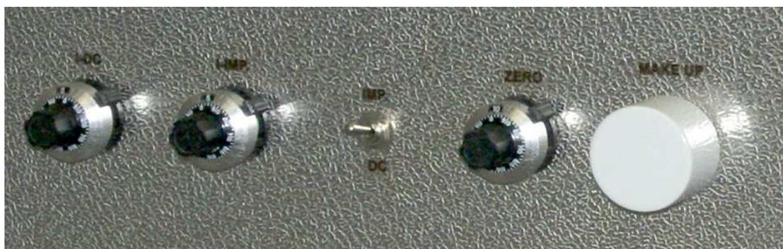
**Fig. 2 : The ECD control elements**
