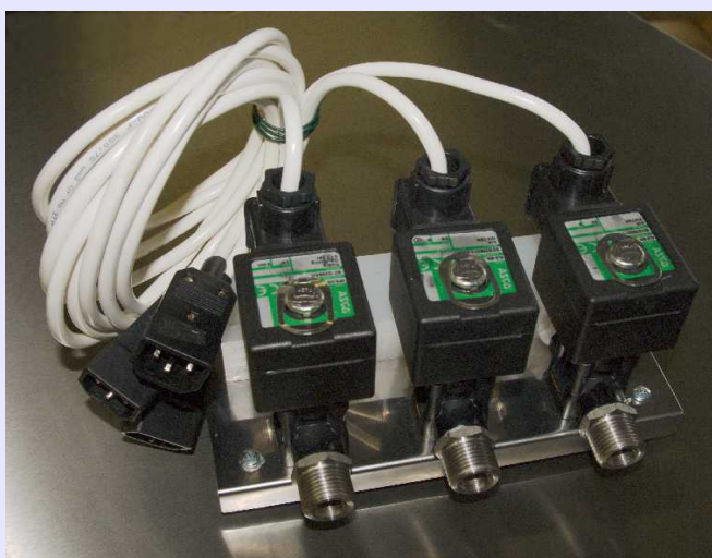
Gradientové ventily pro pumpu PCP P2
